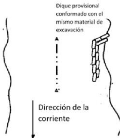
Figura 4. Aislamiento de la zona de trabajo.
